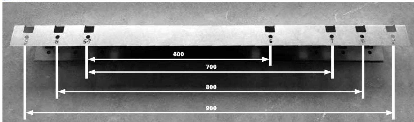
1 Відріжте направляючий механізм на потрібну ширину. 2 Вставте механізм у верхню направляючу, до з'єднання з фіксуючим отвором, зафіксуйте відповідним гвинтом. 3 Розмістіть верхню кришку відповідно до отвору потрібного розміру (еталонні виміри для верхньої та нижньої кришки)
